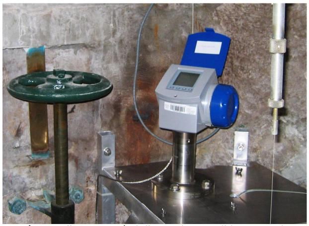
Grâce aux efforts conjugués de l'IGN et du SHOM, l'observatoire de Marseille est équipé d'un MCN moderne et performant qui comprend notamment un télémètre à émission radar et une centrale d'acquisition numérique. La centrale permet de recueillir les mesures de hauteur de niveau de la mer à une période d'échantillonnage inférieure ou égale à 10 minutes. Son fonctionnement est permanent. La <u>précision</u> des mesures est meilleure que 2 cm à 99,5 %.
